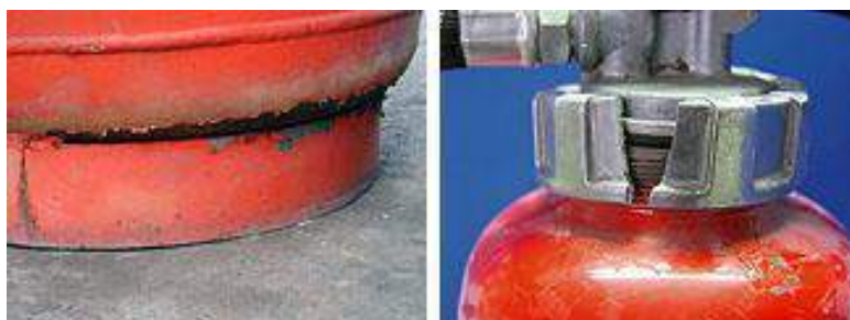
底の塗装がはがれた消火器
