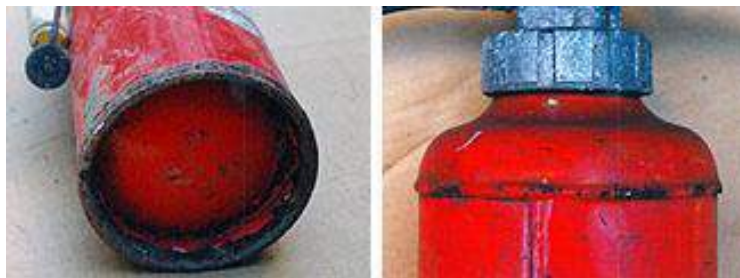
黒く変色している消火器
